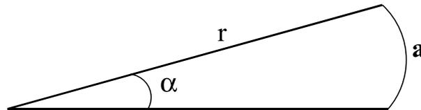
Figura 18.3: Ângulo plano  $\alpha$ , correspondente a um arco  $a$  à uma distância  $r$ .
