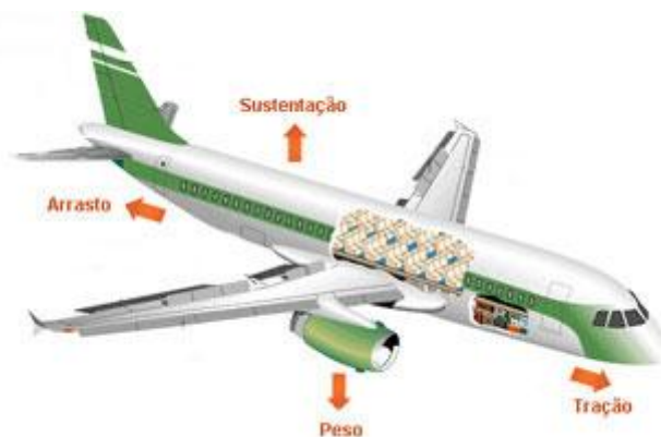
Distribuição de forças aerodinâmicas num avião.
