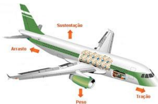
Figura II.15 – Distribuição de forças aerodinâmicas num avião.
