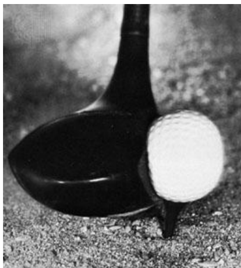
Figura II.24 – Deformação da bola de golfe pelo taco, no instante do choque.
