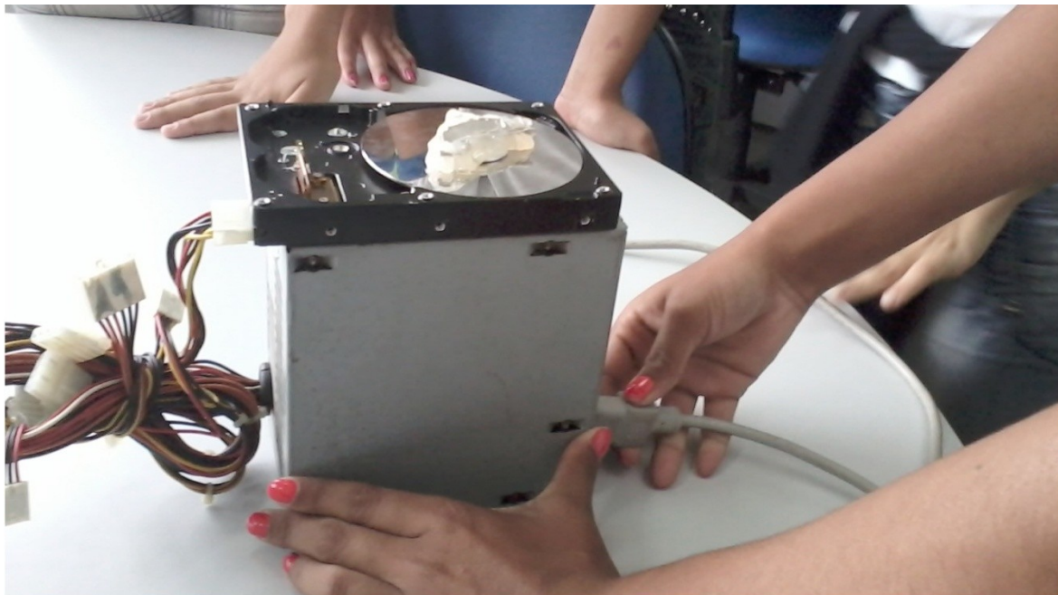
HD sendo conectada na fonte de computador
