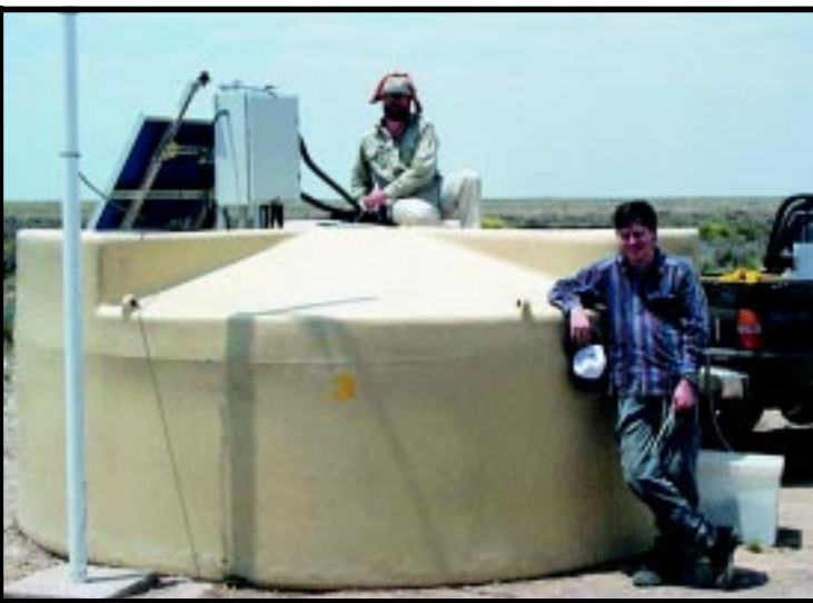
Figura 2. Pesquisadores trabalhando na montagem de um dos tanques Cerenkov feitos no Brasil. No detalhe, o hexágono mostra a área ocupada pelo Observatório Auger, na província de Mendoza (Argentina)
