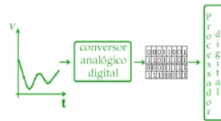
Figura 5. O sinal analógico deve ser transformado em digital para poder ser interpretado pelo computador.
